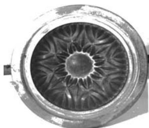
Рис. 4. Металлическая пресс-форма, полученная методом шликерообразования
